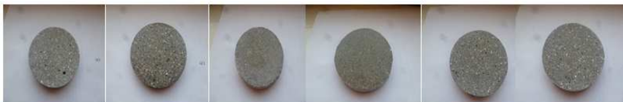
Рис. 1. Образцы жидкого камня без добавки и с добавкой соответственно 0, 15, 20, 25, 30, 35%
