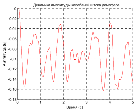
Рис. 3. Реакция демпфера на модулированное воздействие.
