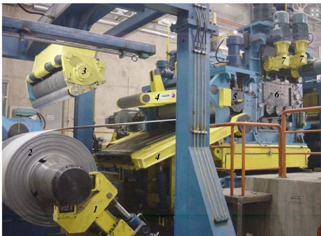
Рис. 1. Разматыватель рулона и шестироликовая листопрямительная машина
