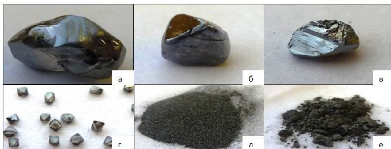
Рис. 4. Образцы после отжига при 1200°C: а- кристалл массой 0,84 карат; б- кристалл массой 0,30 карат; в- кристалл массой 0,18 карат; г- кристаллы размерностью 1000/800; д- шлифпорошок размерностью -30 мкм; е- УДА
