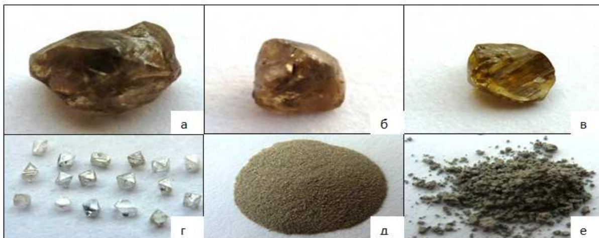
Рис. 1. Образцы в исходном состоянии: а- кристалл массой 0,84 карат; б- кристалл массой 0,30 карат; в- кристалл массой 0,18 карат; г- кристаллы размерностью 1000/800; д- шлифпорошок размерностью -30 мкм; е- УДА
