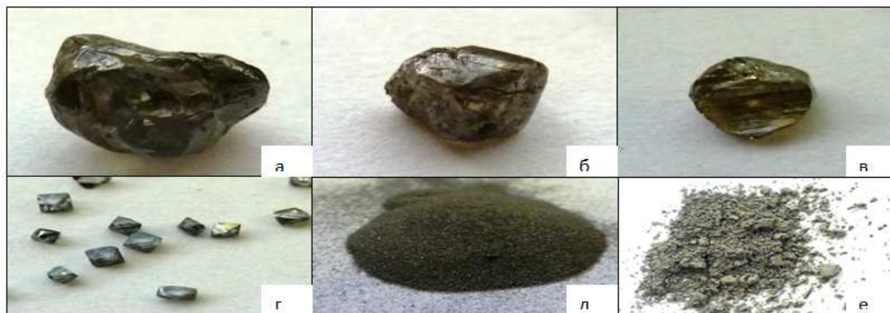
Рис. 2. Образцы после отжига при 800°C: а- кристалл массой 0,84 карат; б- кристалл массой 0,30 карат; в- кристалл массой 0,18 карат; г- кристаллы размерностью 1000/800; д- шлифпорошок размерностью -30 мкм; е- УДА
