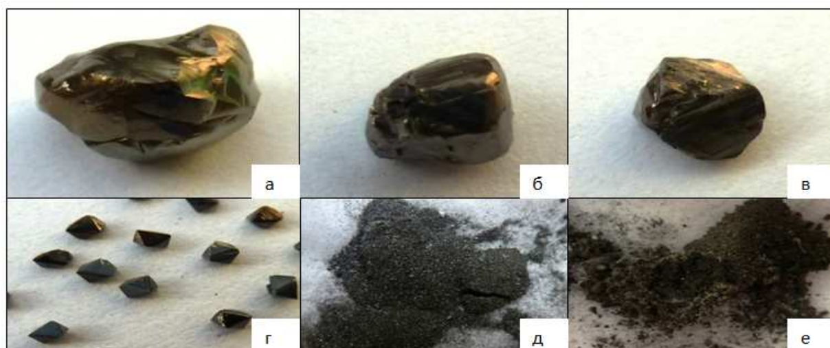
Рис. 5. Образцы после отжига при 1400°C: а- кристалл массой 0,84 карат; б- кристалл массой 0,30 карат; в- кристалл массой 0,18 карат; г- кристаллы размерностью 1000/800; д- шлифпорошок размерностью -30 мкм; е- УДА
