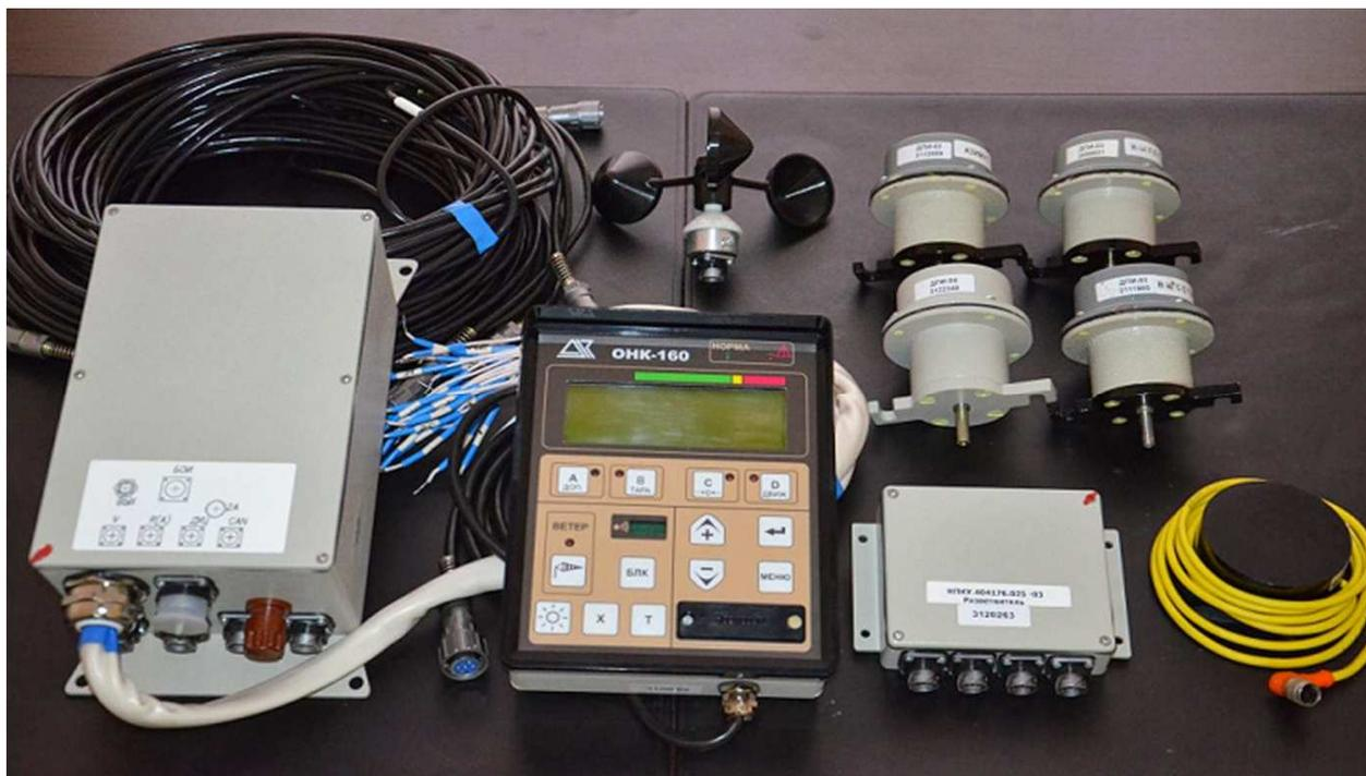
*Рис. 1. Комплект ограничителя грузоподъёмности ОНК-160Б*
